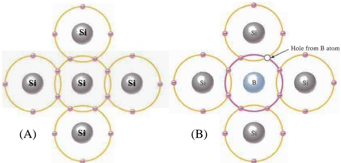
Figure (4): A) Pure Silicon, B) Impurity Silicon crystals
