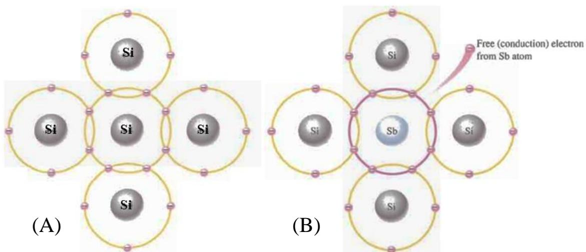
Figure (3): A) Pure Silicon, B) Impurity Silicon crystals
