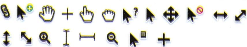
الشكل (2-5) يوضح أشكال مختلفة لمؤشر الماوس حسب الوظيفة التي يعمل عليها الماوس
